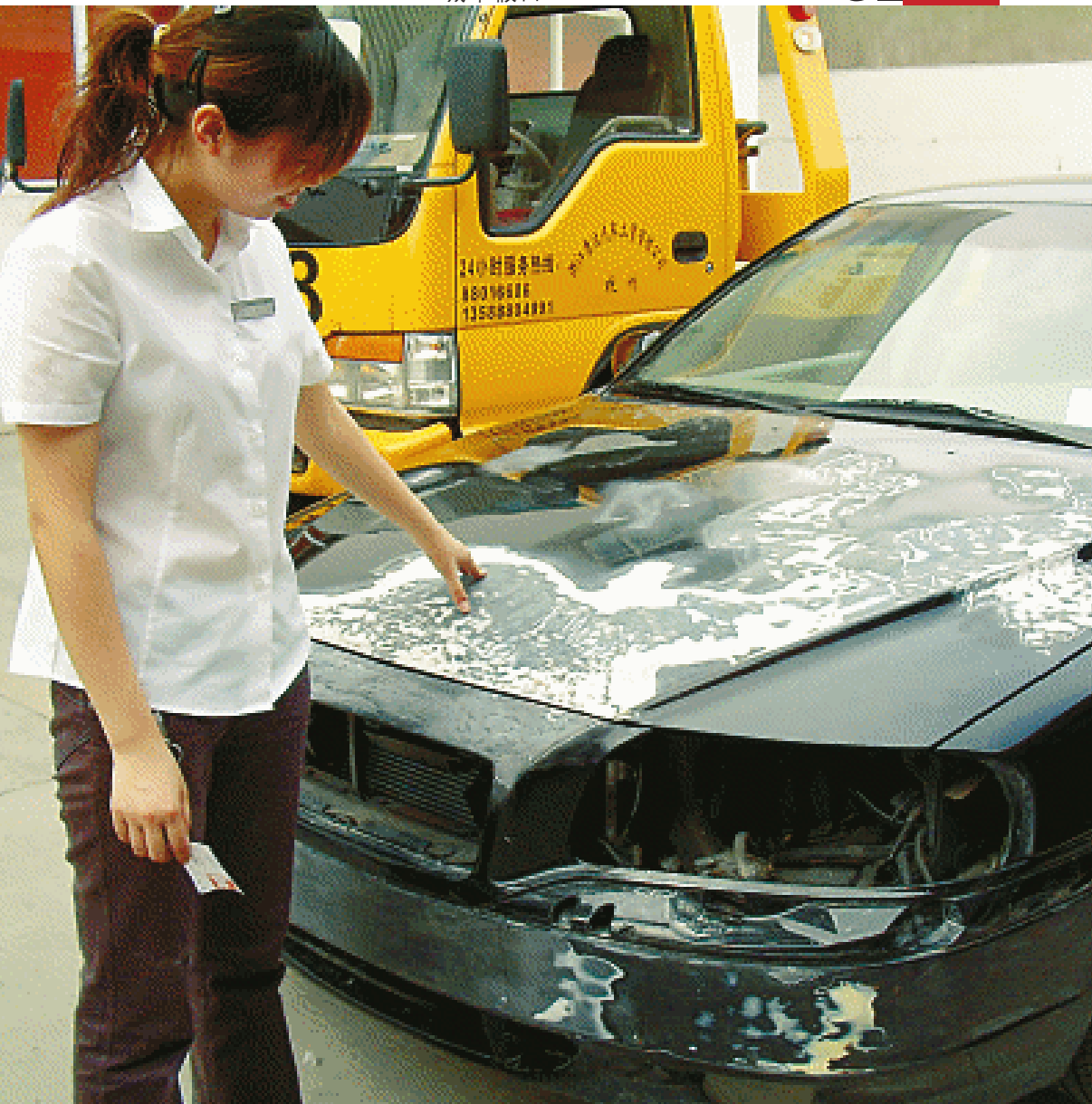
停在修理厂里的沃尔沃车,车盖表面油漆打磨掉后露出一块块带状的石膏
