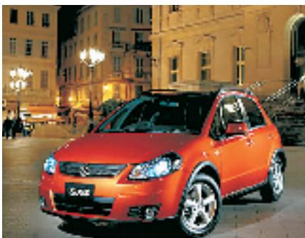
除了原汁原味的运动外观,及出色的底盘性能外,两厢SX4搭载的铃木公司目前最先进的M16A 1.6升DOHC 16气门全铝直列四缸发动机也是一大亮点。这款应用了VVT连续可变正时气门技术的明星发动机,雨燕没有福气享用它,而利亚纳也只能勉强使用一款“缩水版”,直到SX4的到来。其最大功率可达80kW,最大扭矩也提高到144NM,在1.6L级别发动机里表现比较突出,对于提高其运动性有实质性的帮助,并且它油耗经济表现也很出色。
