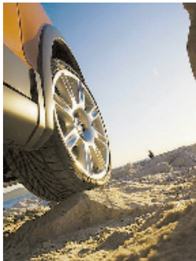
底盘刻意调高 17mm, 获得了比普通轿车更好的路面通过性
